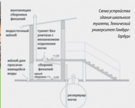
Сухой туалет с механизмом отделения мочи от фекалий, построенный для школы в одной из румынских деревень
