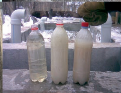
Обработка серых вод в Жетигене (с права на лево): приток, после осаждения, сток
