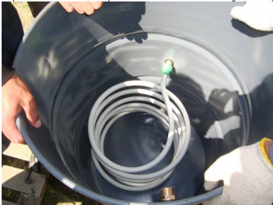
Réservoir d'eau avec système d'échange de chaleur
