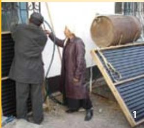
1. Petits modèles de capteurs solaires faits à partir d'anciens radiateurs, atelier effectué au centre d'exposition UGAM, Lenger, Kazakhstan
