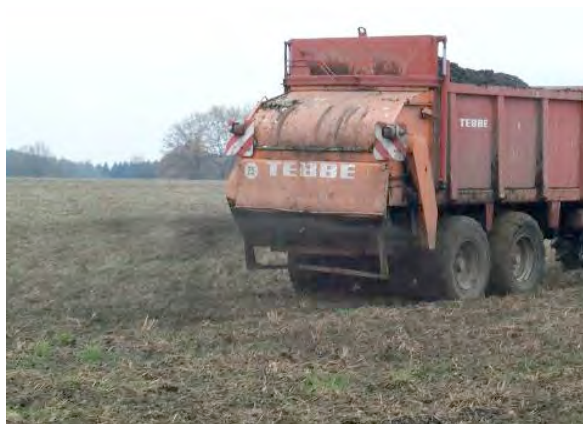
Използване на обезводнена канализационна утайка в селскостопанска нива в Германия
