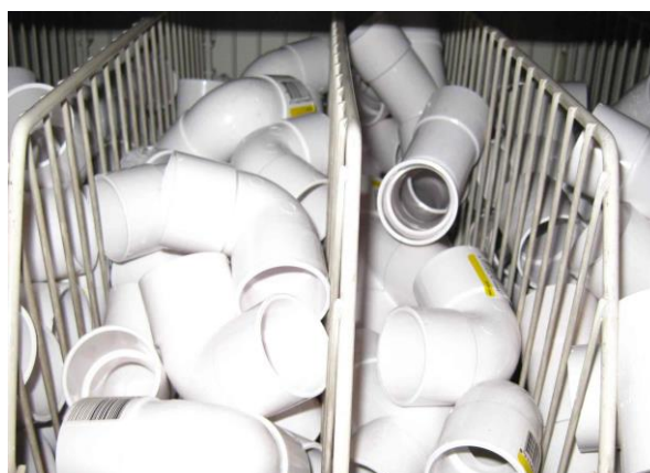
Conductele și fittingurile de plastic sunt din ce în ce mai folosite la sistemele de distribuție a apei casnice și publice
