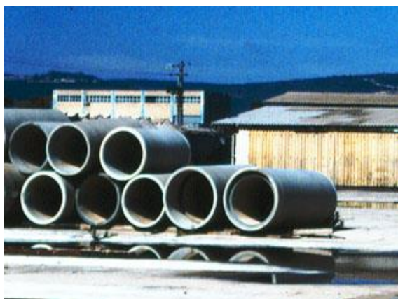
Conductele de azbociment au fost utilizate pe scară largă la distribuția de apă potabilă, mulți kilometri de astfel de conducte putând fi regăsiți în întreaga lume.
