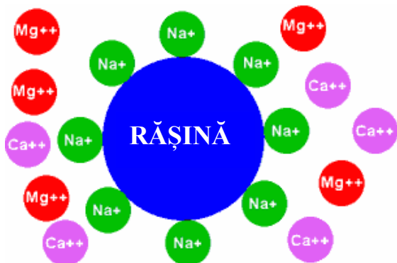
Figura 3: Rășină schimbătoare de ioni complet încărcată
