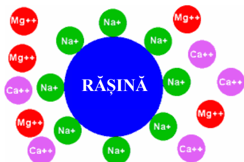
Figura 3: Rășină schimbătoare de ioni complet încărcată
