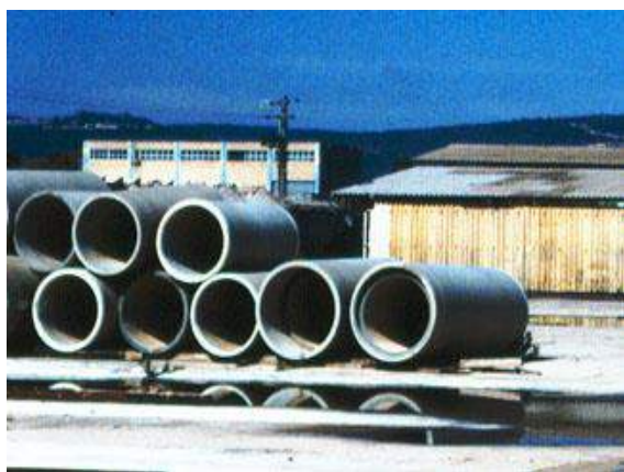
Conductele de azbociment au fost utilizate pe scară largă la distribuția apei potabile, mulți kilometri de astfel de conducte putând fi regăsiți în întreaga lume.
